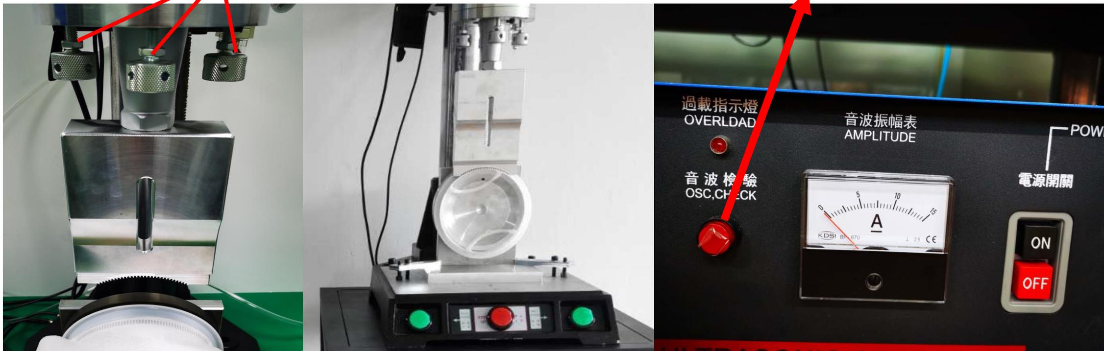
第五.调试上下模具位置：首先确定选择按钮在手动状态下，启动两个绿色按钮使得上模具降下来并将模具四周的四个水平螺丝松开（把上模具位置调正），将机架左侧两个黑色锁柄松开，通过右侧摇轮进行上下模具吻合在一起，此时双手同时操作将对角的两个水平螺丝拧紧（水平螺丝松的一侧先拧紧，然后同时受力拧紧，使得模具与底模具吻合），将机架左侧两个黑色锁柄锁紧，底模具两侧的压板固定紧。此时按红色按钮，使得上下模具分离。
