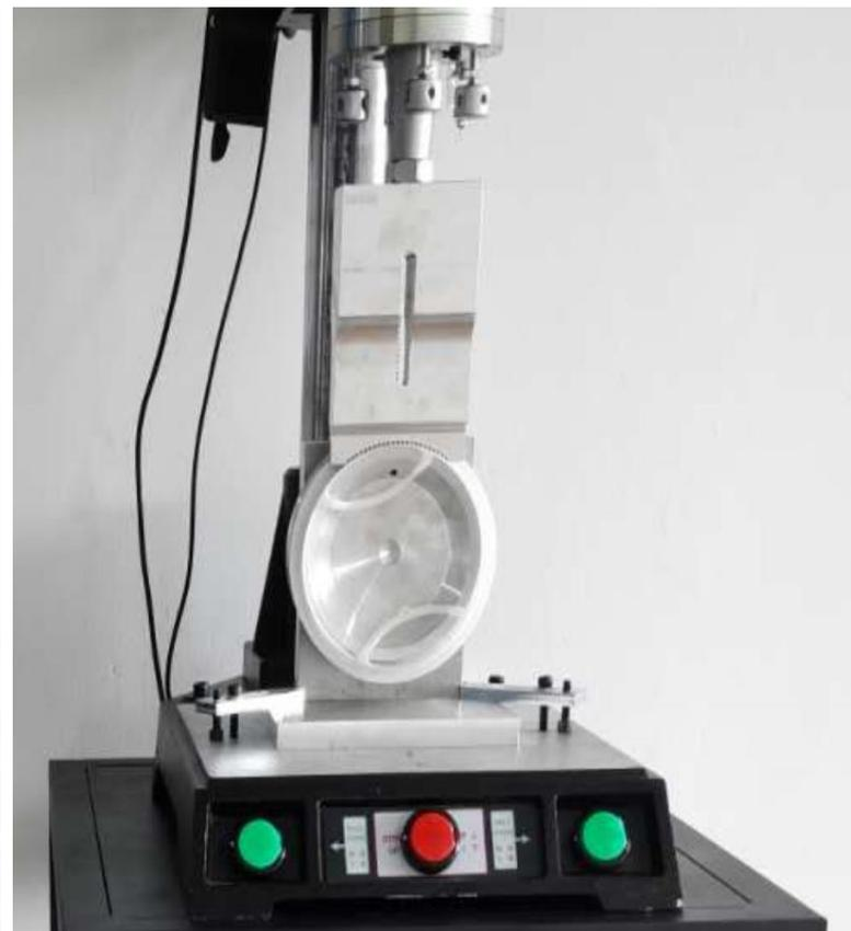
第六.调整压力表 (0.5MPA-0.6MPA),延迟时间代表机头工作降下来的时间,焊接时间代表超声波工作时间,硬化时间代表焊接后保压冷却时间。将选择开关拨至自动。此时,将焊接的产品摆放在底模具上,注意双手离开上下模具的区域防止压伤手指,再双手启动按钮(机头下降就可将双手离开绿色按钮,无须一直按着两个绿色按钮)。焊接时间在保证焊接产品牢固的情况下,越小越好。
