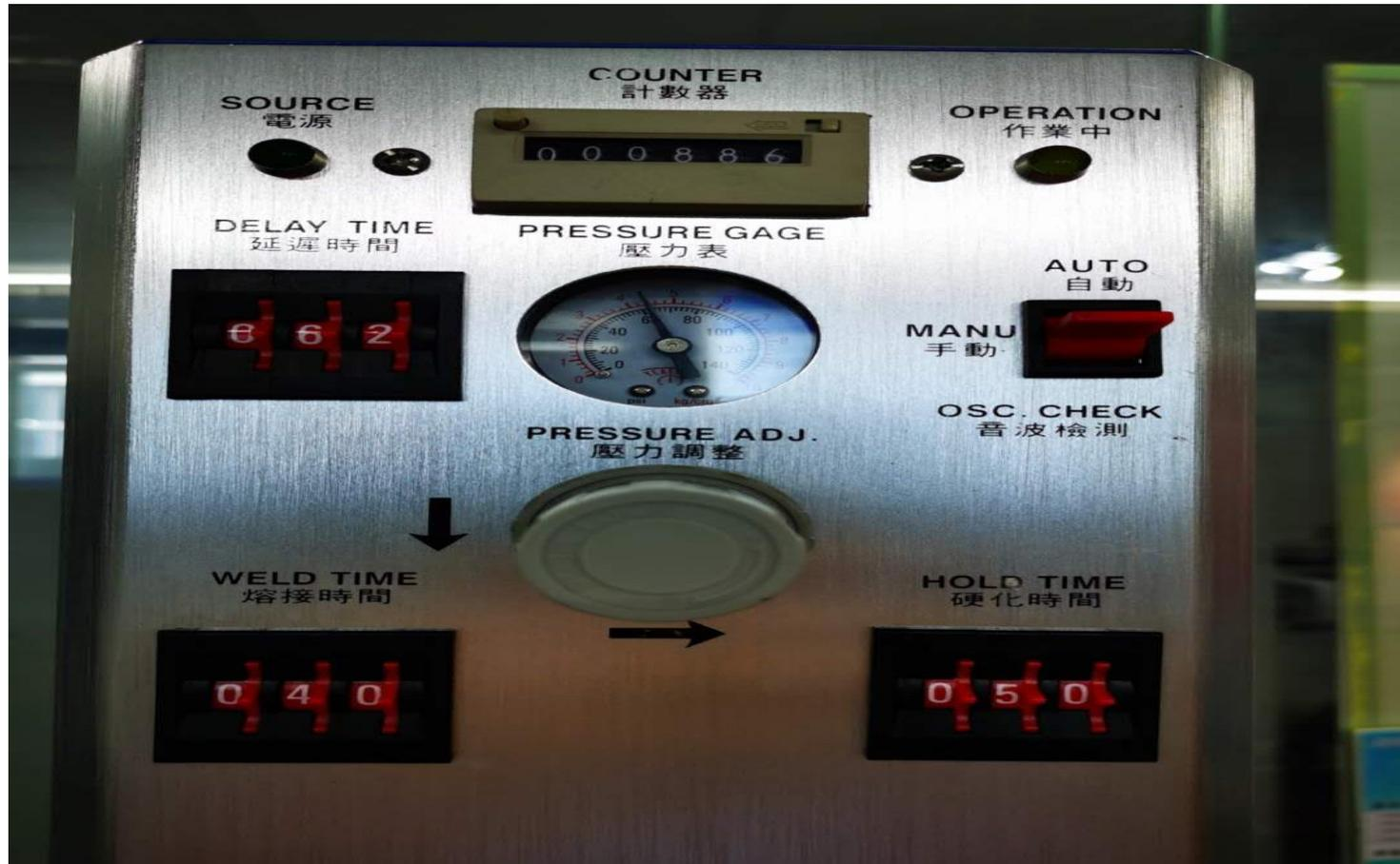
第四.将模具装紧在机器上，一定要用扳手或者橡胶锤子固定紧。然后在控制箱上进行音波测试：轻轻按音波检测按钮（控制在1-3秒内）观察音波振幅表摆动及过载指示灯，过载指示灯不亮红灯及音波振幅表摆动两小格以内，说明模具装配在机器上是正确的。如果过载指示灯亮红灯，音波振幅表摆动超过三小格以外，则说明模具没有安装紧需要用橡胶锤敲击，或者模具裂开需要更换模具。
